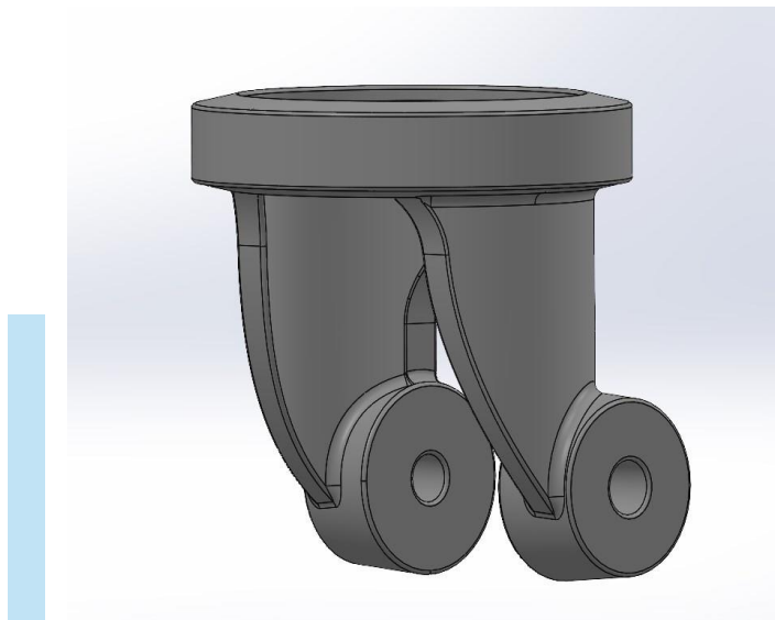
Figura 10: modello 3D del "Frame" dopo l'aggiunta dei raggi di raccordo
