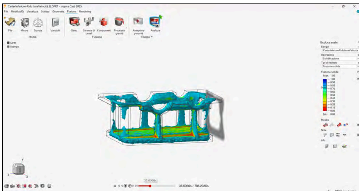
Inspire Cast- Simulazione approssimativa della solidificazione
